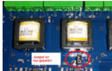
Abb.: Jumper Mikrofon Verstärkung EVA16 2.0 default
